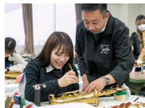
1年次の基礎では、管楽器の取り扱いから分解組立、タンボ交換やピストン調整など、基本的な修理技術を学びます。2年次の応用では、課題の難度をあげ、より繊細な調整方法を学びます。また、作業を効率化し反復練習を行うことで精度を高めます。
